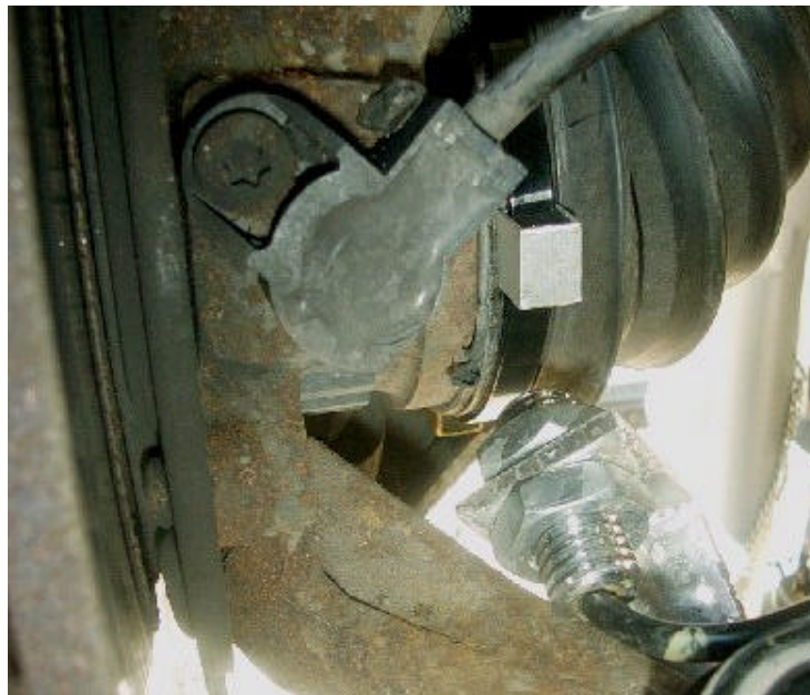
GENERATEUR CARDAN INSTALLE SUR UN VEHICULE
