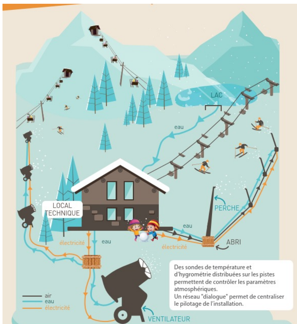
Schéma général d'implantation d'une installation d'enneigement
