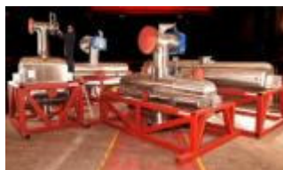
Figure 9. Echangeurs microstructurés PCHE proposés par Heatric
