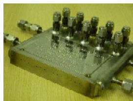
Figure 8. Micro-réacteur développé à l'Université de Bath (Royaume-Uni)
