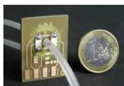
Figure 11. Micro-valve développée par l'Université de Rostock (Allemagne)
