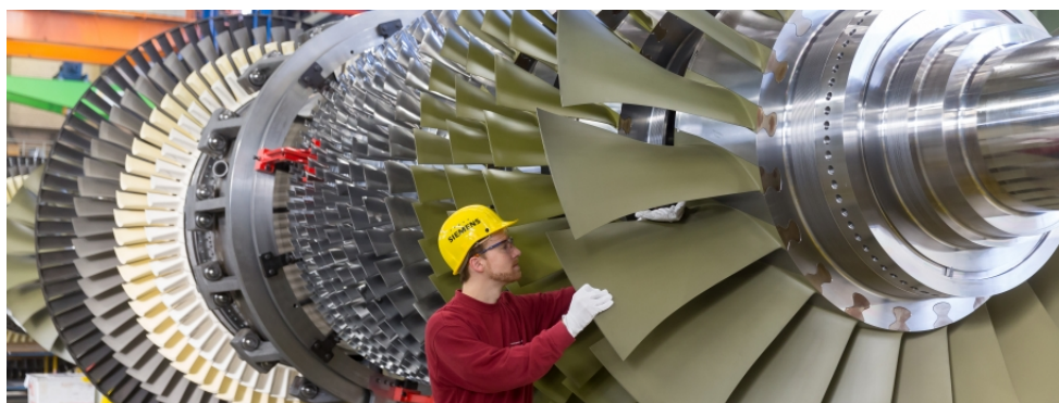
Figure 155 - Turbine à gaz de SIEMENS. Optimisation de maintenance par IA
