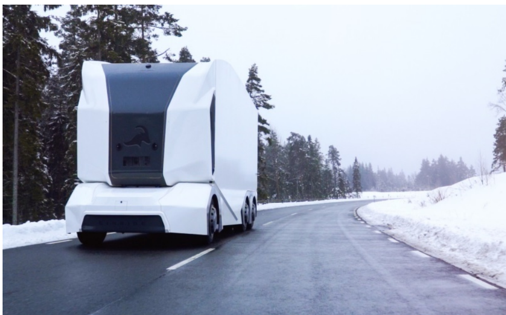
Figure 144 - T-POD, premier camion autonome et électrique
