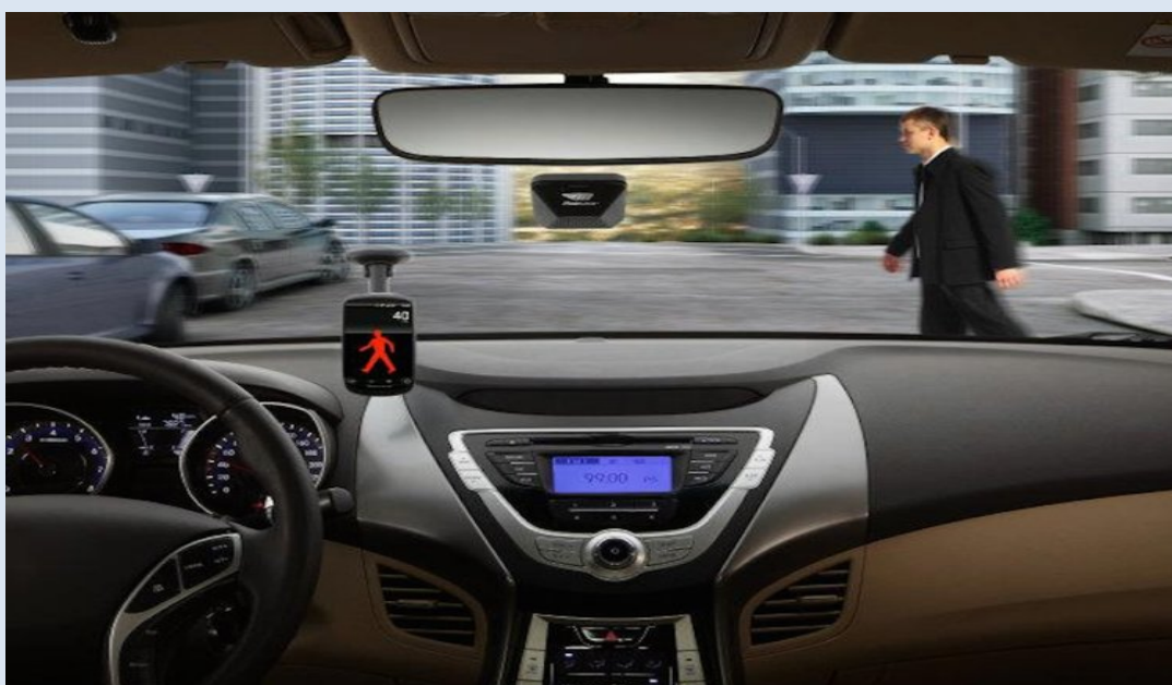
Figure 72 - MOBILEYE interprète un flux vidéo pour avertir les conducteurs des dangers imminents 58
