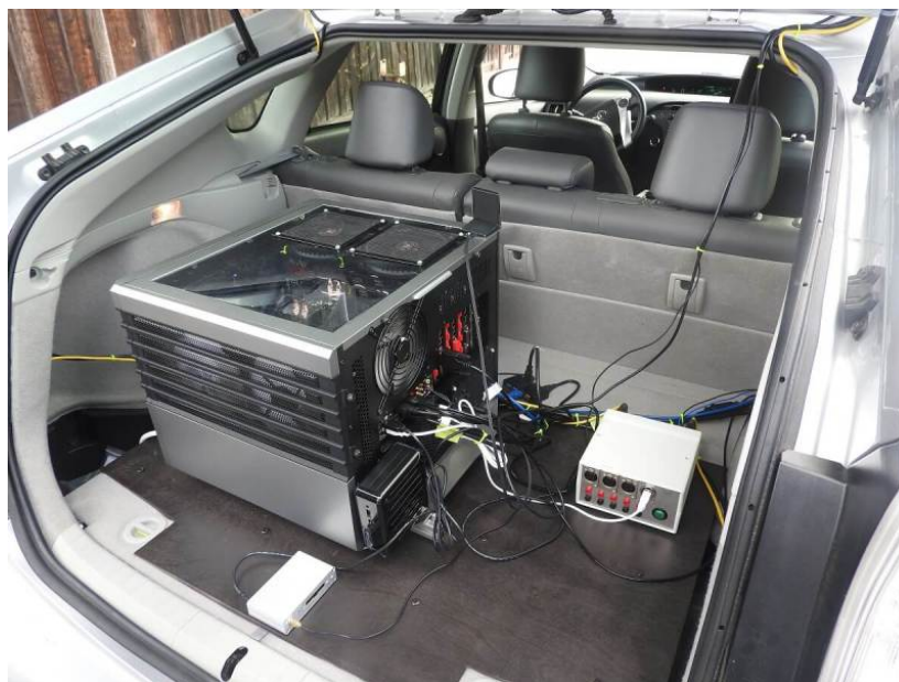
Figure 101 - L’ordinateur qui fournit la puissance de calcul du véhicule AIMOTIVE
