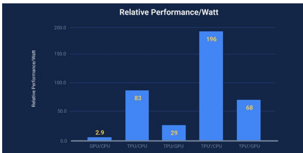
Figure 14 - Performance comparée des processeurs 26
